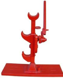
Die "Swiss-Made"-Bobinenwinden dienen zum Abheben der Seiltrommeln (benötigt 2 Stück) für das Auf- und Abwickeln von Drahtseilen. Die Winden zeichnen sich durch kleines Eigengewicht und grosse Tragfähigkeit sowie durch die grosse Fussplatte, die ein Wegrutschen oder Umkippen verhindert, aus. Die Bobinenwinden sind mit solidem Rätchen-Sicherheitshebel inkl. Bedienungsstab ausgerüstet.
