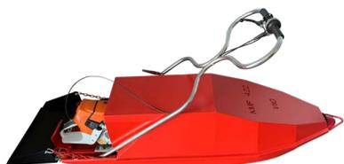
Die Ackja-Seilwinde ist eine extrem leicht gebaute Seilwinde, die auf einem Ackja (einer Gleitwanne) montiert ist. Selbst in unwegsamstem Gelände zieht sich die Seilwinde zum Einsatzort und dient für verschiedenste Einsatzmöglichkeiten. Bedienung erfolgt über einen Lenkholm. Angetrieben wird das Windenaggregat von einem Motorsäge-Motor (Stihl 661).
