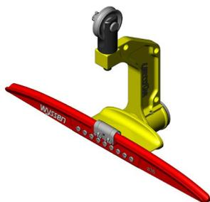
Der Wyssen-Tragseilsattel Typ 5 wurde für höhere Seilspannungen und Nutzlasten entwickelt. Er dient bis zu einem max. WLL Satteldruck von 12 t (Sicherheitsfaktor 5) und max. Seilabwinklung von 30°. Der Sattel Typ 5 kann für die Laufwagen 5 t, HY-7, Motorseilkran MSK 2 verwendet werden. Bei höheren Belastungen können ebenfalls zwei Sättel mit der Wyssen-Stützenwaage verwendet werden.
