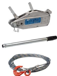
Der qualitativ hochstehende original Seilzug Habegger Hit aus legiertem Leichtmetallgehäuse ist für maximale Zugkräfte von 600 kg bis 3200 kg erhältlich. Dank Überlastsicherung durch Abscherstift und des passend für den Seilzug entwickelten Seils wird höchste Sicherheit geboten. Der Seilzug Habegger wird weltweit, auch im Seilbahnbereich, für verschiedenste Anwendungen verwendet. Wir bieten auch den Ausbau zum Hydraulikantrieb an.
