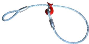
Die Seilstruppen mit Gleithaken (Seilkonstruktion 6x36WS+FC/verzinkt) dienen zum Aufhängen vom Tragseilsattel, Endmastsattel und Endmastrolle an Baumstützen. Ein schnelles und sicheres Aufhängen wird ermöglicht. Auf Wunsch stellen wir Ihnen auch Seilstruppen in anderen Längen bis max.  $\varnothing$  24 mm her.
