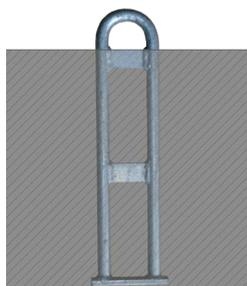
Für Stützenabspannungen sind auch Ankerbügel-Agraffen mit oder ohne Querplatten erhältlich und je nach Typ bis 10 Tonnen belastbar. Zum Einbetonieren werden die Ankerplatten mit Querplatten und zum Eingiessen für Felsanker ohne Querplatten verwendet.
