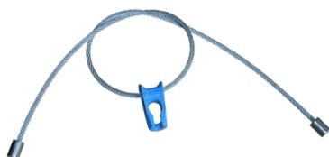
Die Chokerstruppen mit Schlingenhaken (Seilkonstruktion 6x25FW+WC/verzinkt) und beidseitig mit Pressmuffe, sind im Durchmesser 11 mm bis 13 mm in verschiedenen Längen verfügbar. Die Wyssen-Hakenschnellen sind rissgeprüft und bestehen aus hochwertigem Material, die jeweils je nach Struppenlänge in entsprechender Farbe gekennzeichnet sind. Auf Wunsch stellen wir Ihnen auch Chokerstruppen in anderen Längen her.
