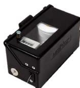
Das bewährte, leichte und kompakte Fadenmessgerät in stabilem Kästchen dient zum Ausmessen der Länge von Seilbahnen. Der Faden reicht für 2700 m und ist biologisch abbaubar. Das Kästchen kann einfach am Gürtel befestigt werden. Die Zählleinheit kann durch Knopfdruck einfach zurückgesetzt werden.
