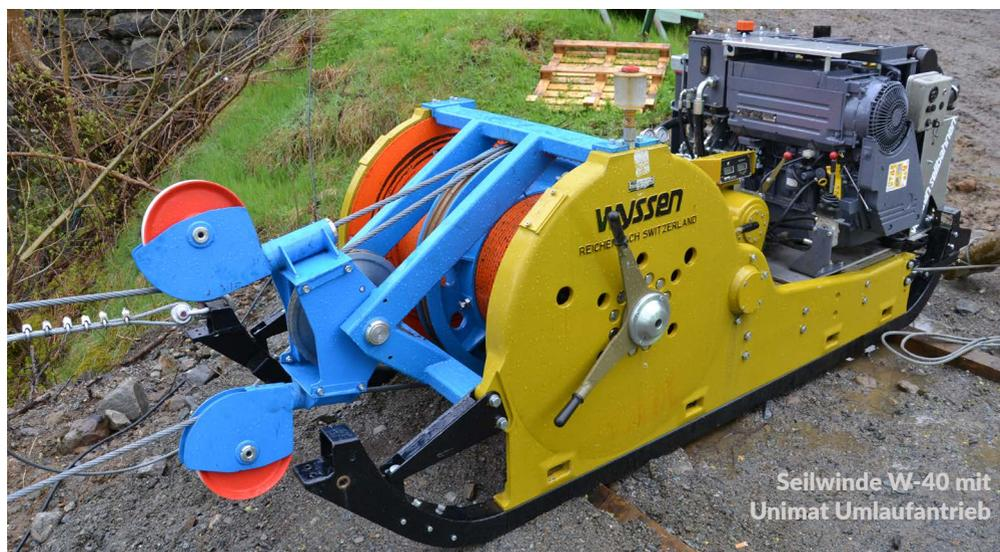
Seilwinde W-40 mit Unimat Umlaufantrieb
