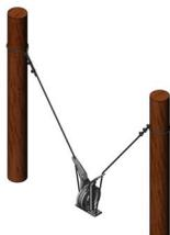
Die Zugseiltragrolle wird dort eingesetzt, wo das Zugseil sehr stark am Boden streift. Damit können starke Abnützungen am Zugseil verhindert werden. Die Zugseiltragrolle wird mit zwei Fängerseilen am Stützen- und Hilfsmast aufgehängt und am Boden mittels Ankerseil befestigt oder festgeschraubt.
