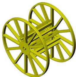
Die Seilhaspel aus Stahl ist in zwei Grössen erhältlich und je nach Typ verzinkt oder Rostschutz mit gelber Farbe verfügbar. Zu jeder Seilhaspel wird auch eine Reduzierhülse mitgeliefert, womit der Lochdurchmesser für die Welle von 81 mm auf 62 mm reduziert werden kann. Die Haspel ist unter anderem auch vorbereitet für den einfachen Anschluss (Mitnehmerzapfen) zum Wyssen-Bobinenantrieb.
