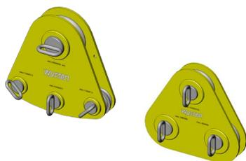
Die Mehrbaumverankerung verteilt die Tragseilspannung auf mehrere Bäume. Wenn nicht genügend starke Ankerbäume für eine herkömmliche Verankerung vorhanden sind, können zur Verankerung des Tragseiles mit der 12-fach Mehrbaumverankerung bis zu 7 Bäume und mit der 4-fach bis zu 3 Bäume verwendet werden. Bei korrekter Anwendung (nur eine Baumumschlingung) verteilt sich die Zugkraft gleichmässig auf die Ankerbäume.
