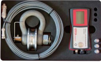
Elektronischer Spannungsmess - Schäkel
