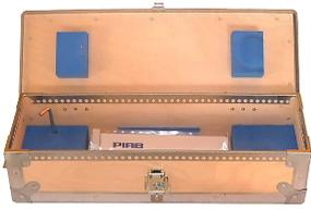
Der Spannungsmesser PIAB wird unter anderem bei der automatischen Trageiseilklemme eingesetzt. Das analoge Messgerät benötigt keine Batterien. Die Messung wird im Spannseil vorgenommen, deshalb muss immer der Multiplikationsfaktor des Flaschenzugs beachtet werden. Die Messungen dürfen nur im Stillstand abgelesen werden. Der Spannungsmesser PIAB wird mit Schäkel und Holzbox geliefert.
