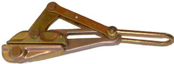
Die Seilspannklemme Bugnard mit Festhaltefeder dient zum Ziehen, Heben und Sichern von Drahtseilen. Die aus Spezialstahl und im Gesenk geschmiedete Klemme ist parallelspannend mit glatten Klemmbacken, die innenseitig mit V-Profil versehen sind.
