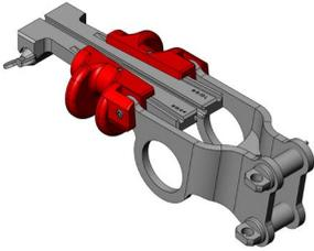
Die Keilklemme mit Doppellasche ist praktisch identisch zur Keilklemme mit Einfachlasche. Die doppellaschige Keilklemme ist ausgerüstet mit zwei Bolzen und hat zusätzlich ein Loch in den Laschen, dadurch kann mit einem Stab/Holz ein Verdrehen der Keilklemme verhindert werden. Ein Bolzen dient als Befestigung zum Zuziehen und mit dem anderen Bolzen kann eine zweite z.B. fixe Befestigung eingehängt werden, womit die Befestigung des Zuziehbolzen problemlos gelöst werden kann.
