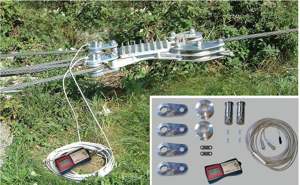
Elektronischer Spannungsmesser mit Messbolzen
