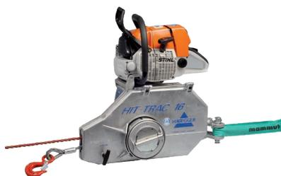
Der original Motorseilzug Habegger Hit-Trac bietet dank guter Materialien, durchdachter Konstruktion und Sicherheitsvorrichtungen höchste Qualität und Sicherheit. Der Hit-Trac ist mit 2-Takt-Antriebsmotor Stihl sowie mit Elektro-Antriebsmotor erhältlich. Die Zuggeschwindigkeit beträgt beim Hit-Trac 8 max. 6 m/min und beim Hit-Trac 16 max. 10 m/min. Alle Geräte sind mit einer Überlastsicherung ausgerüstet, womit höchste Sicherheit gewährleistet werden kann.
